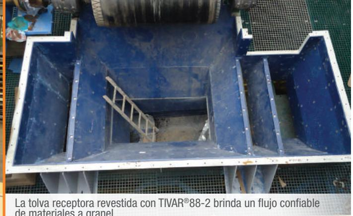
La tolva receptora revestida con TIVAR®88-2 brinda un flujo confiable de materiales a granel.
